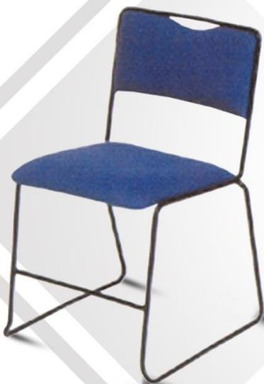
Estructura fabricada en acero redondo macizo de  $\frac{1}{2}$ " con refuerzo al frente del mismo material, electrosoldada con micro alambre con tratamiento anti-corrosivo acabado en pintura electroestática, micropulverizada horneado a  $200^{\circ}$ .
